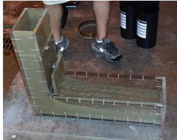
Fig: L Box Test
