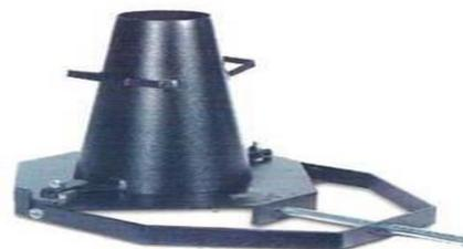
Fig: Slump test
